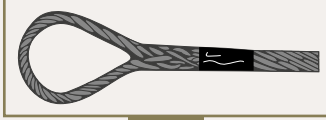
%80 Örgülü sapan dönmeye karşı Korunmalıdır. %80 Sliced loop. Loops must be secured against twisting. >%80 EN 13414
