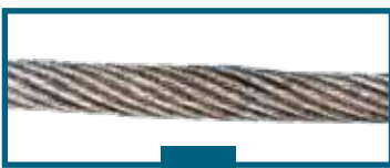
Öz hasarlanmasından kaynaklı çap artışı Local increase in rope diameter due to core distortion
