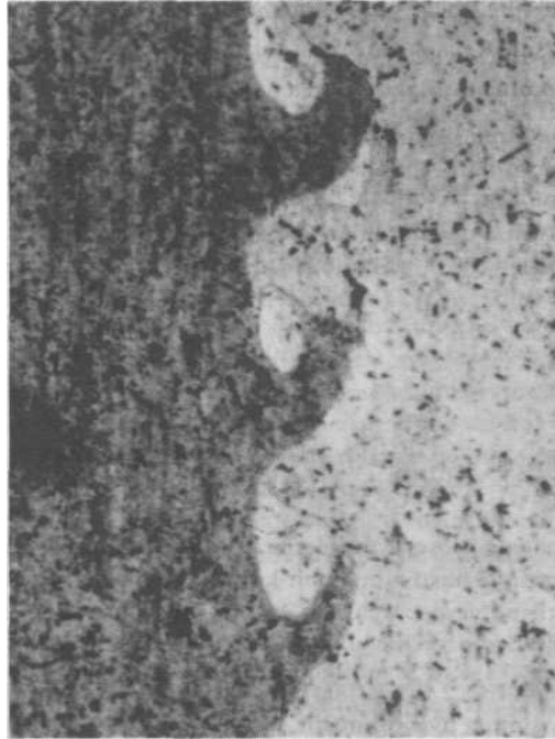
Şekil: 220 — Bir patlama kaynağının mikrofotoğrafları. Dalgacıkları haiz yüzeyarası görülür.
